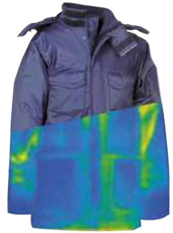
La couleur tendant vers le bleu indique le manque de fuite d'air chaude du vêtement.
