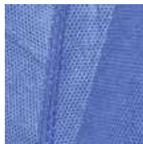
coutures thermosoudées par ultrasons
